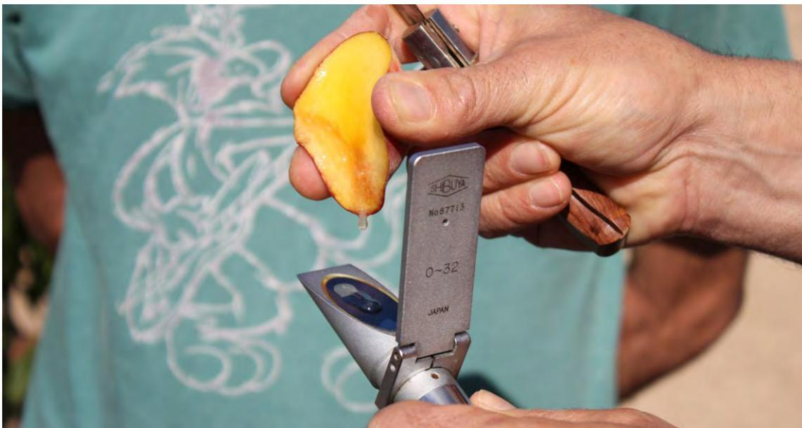
Técnico de Transferencia Tecnológica realizando medición de grados brix en fruto.
