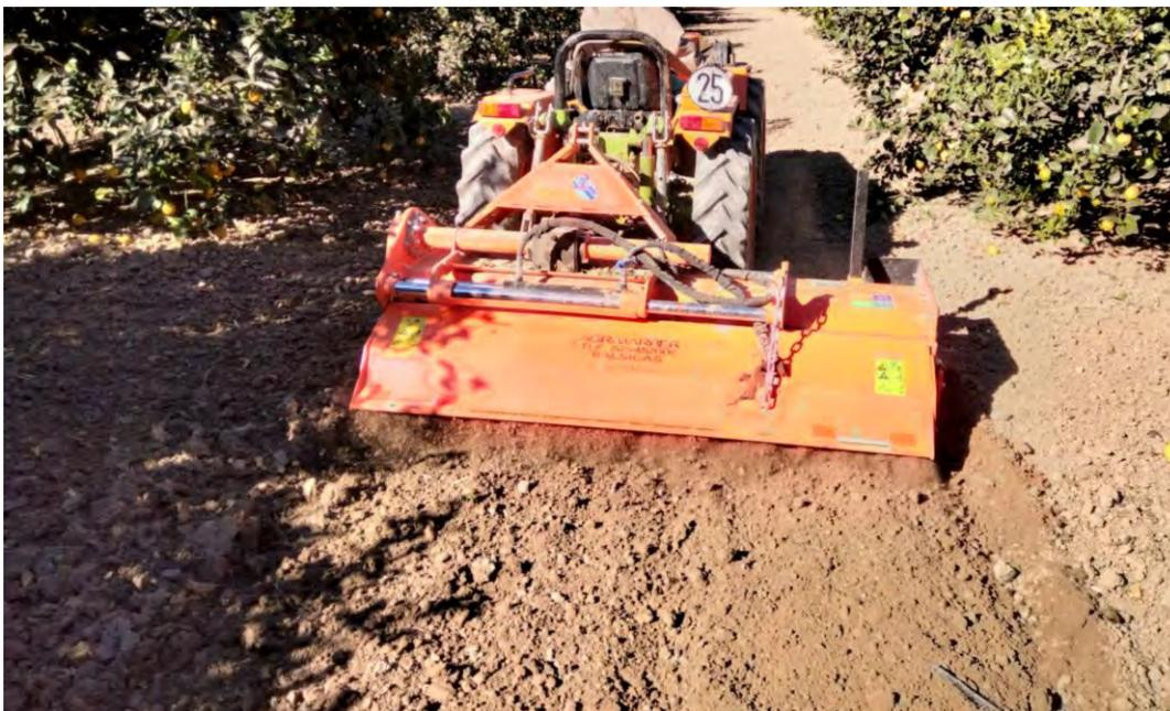
**Imagen 3.** Labor superficial de fresadora para enterrar la semilla.
