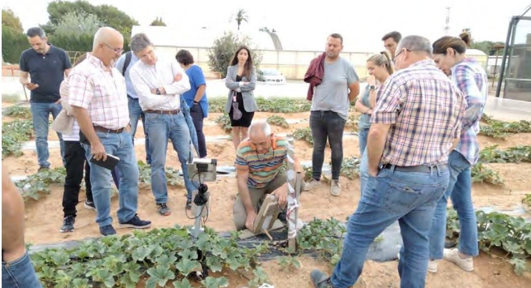
Imagen nº 12: Técnicos de la empresa Nutricontrol y técnicos del CIFEA de Torre Pacheco, extrayendo lixiviados de un lisímetro para analizar la composición del mismo, en presencia de técnicos agrícolas.
