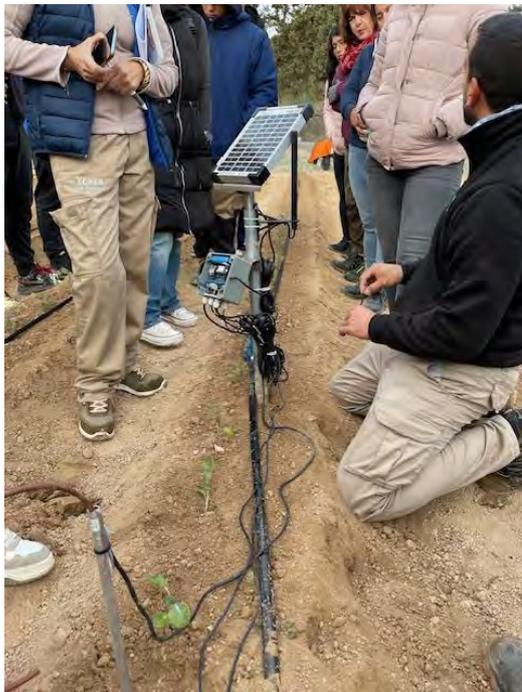
Imagen nº 10: Técnicos de la empresa widhoc instalado un dispositivo para control de humedad del suelo a distintas profundidades en presencia de técnicos agrícolas
