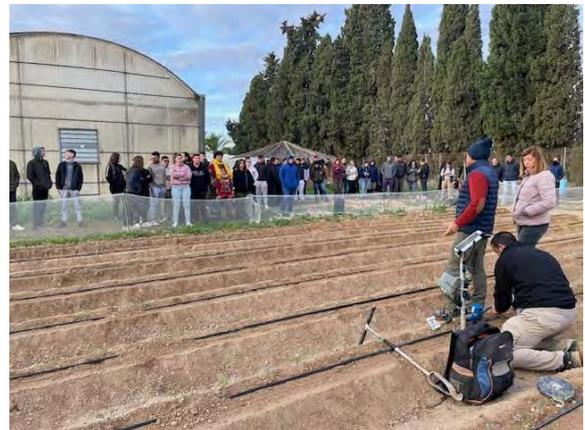
Imagen nº 11: Técnicos del CIFEA y de la empresa widhoc instalado un dispositivo para control de humedad del suelo a distintas profundidades en presencia de alumnos.
