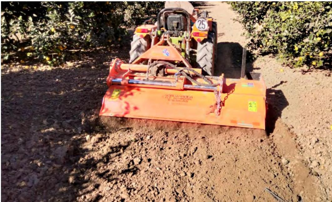
**Imagen 5.** Labor superficial de fresadora para enterrar la semilla.
