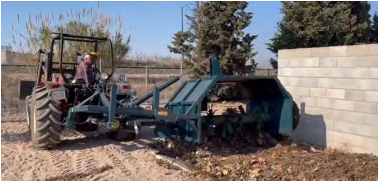
Imagen nº 8. Volteadora acoplada al tractor y trabajando en el proceso de volteo.
