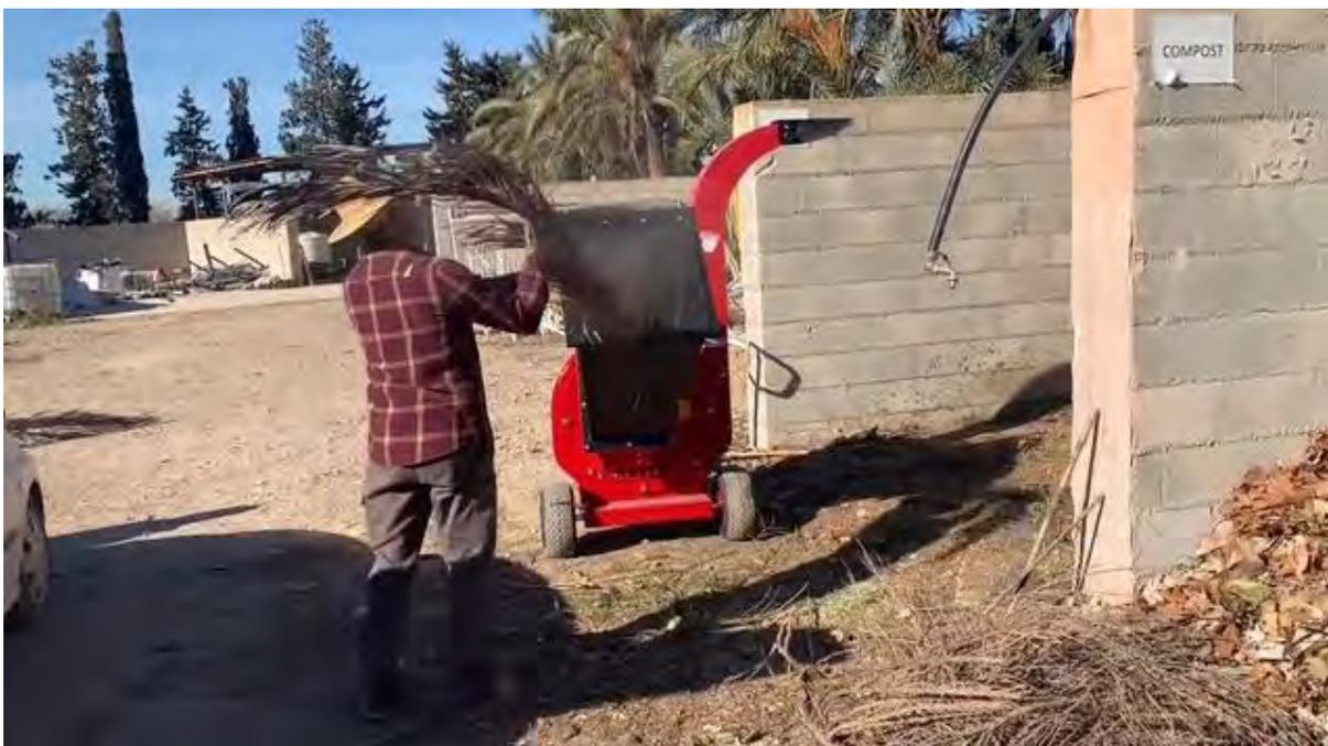
Imagen nº 7: Biotrituradora en funcionamiento en la zona de acúmulo de restos vegetales.
