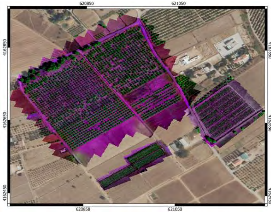
Figura 4. Detalle de cultivos supervisados mediante teledetección con dron (representación en falso color RGB = NIR-RED-BLUE de 12/10/2023).
