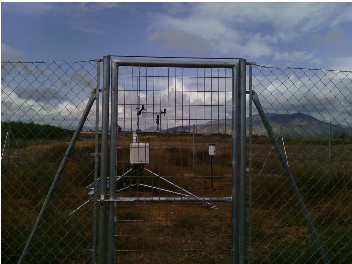
En este sentido, esta estación registra distintos datos agrometeorológicos, como temperatura y humedad relativa, velocidad y dirección del viento, precipitación, radiación global incidente, punto de rocío, déficit de presión de vapor o evapotranspiración de referencia.
