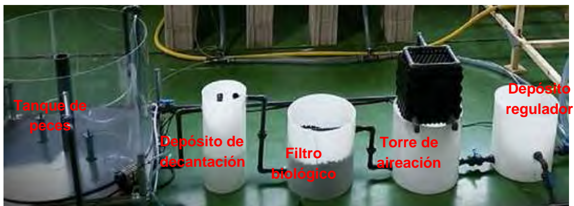
Foto nº 5. Elementos del sistema de cría de peces y nitrificación de los desechos.
