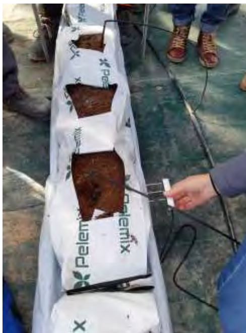
Foto nº 4. Colocación de sondas de humedad en saco de fibra de coco para hidroponía (08/11/2019).
