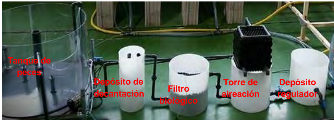
Foto nº 7. Elementos del sistema de cría de peces y nitrificación de los desechos.
