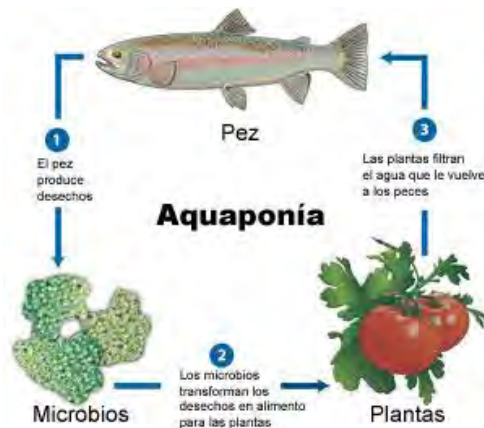
Figura 1: Fundamentos de la Acuaponía.
