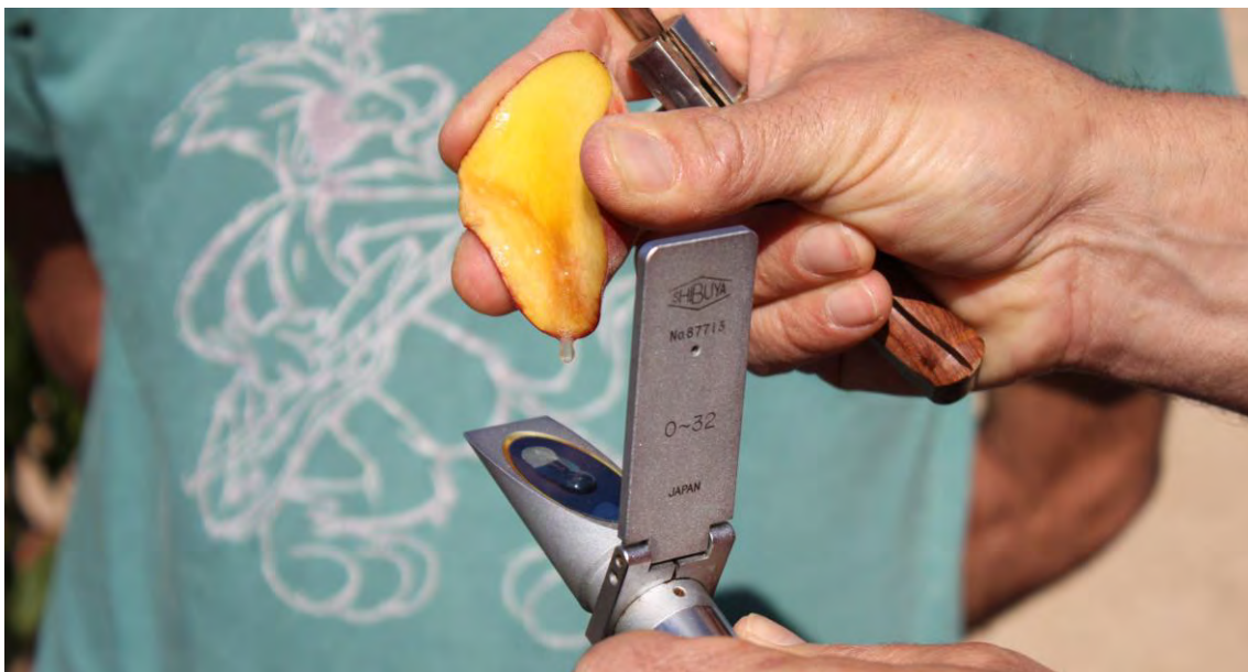
Foto nº 5. Medida de los grados Brix con refractómetro.
