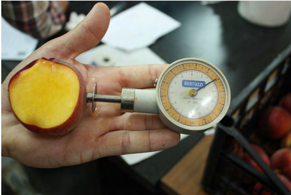
Foto nº 19. Medida de la dureza con penetrómetro, previamente a la recolección.
