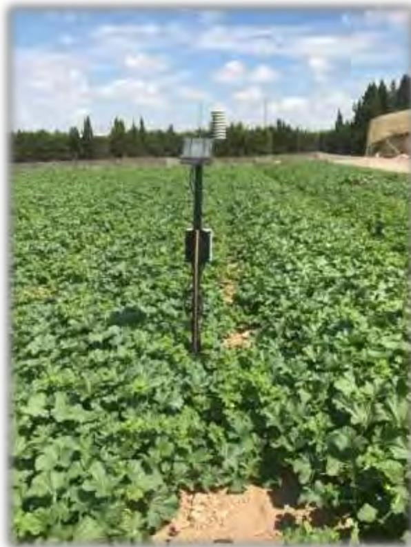
**Imagen nº4** Sensores de humedad de suelo en melón
