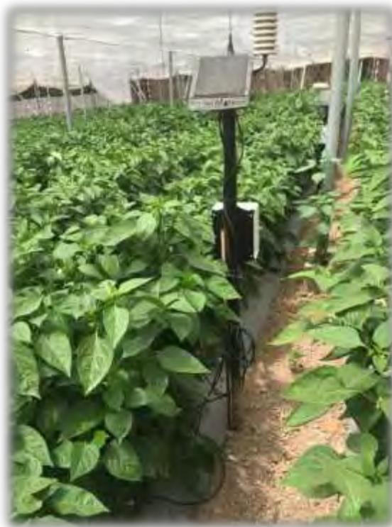
Imagen n°5 Equipo de tensiómetros de humedad de suelo
