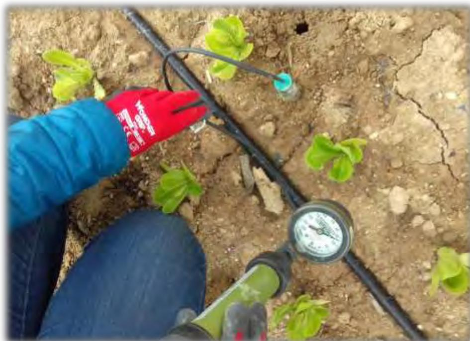
**Imagen nº4** Obtención vacío en la sonda de succión
