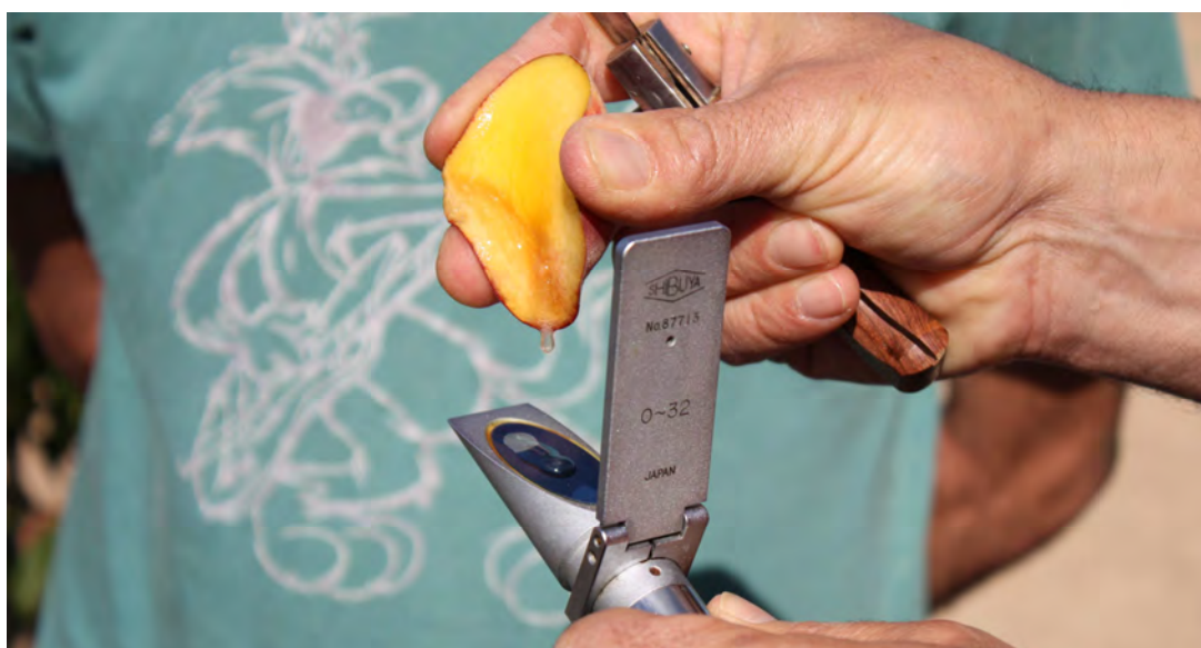
Foto nº1. Medida de los grados Brix en frutos con el refractómetro.
