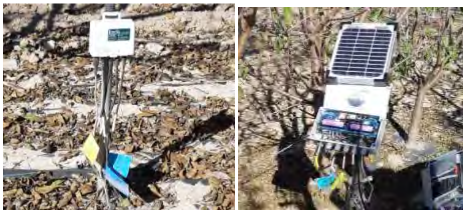
Sensores colocados en la parcela y datalogger alimentado por placa solar.
