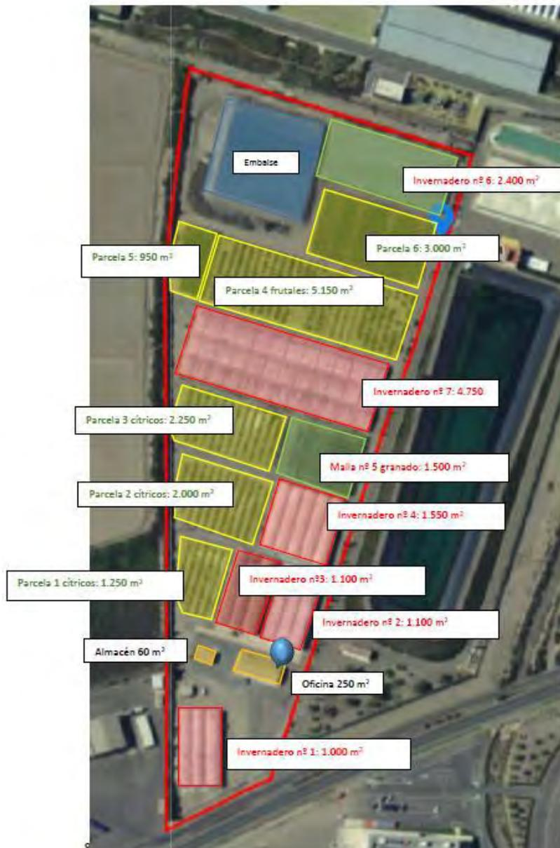
El invernadero nº 7 se corresponde con una estructura de malla de 20x10 hilos con una superficie total de 4.750 m<sup>2</sup> y opción a cubierta de plástico térmico temporal. Construido en 2015. Dispone de 5 sectores de riego diferenciados.
