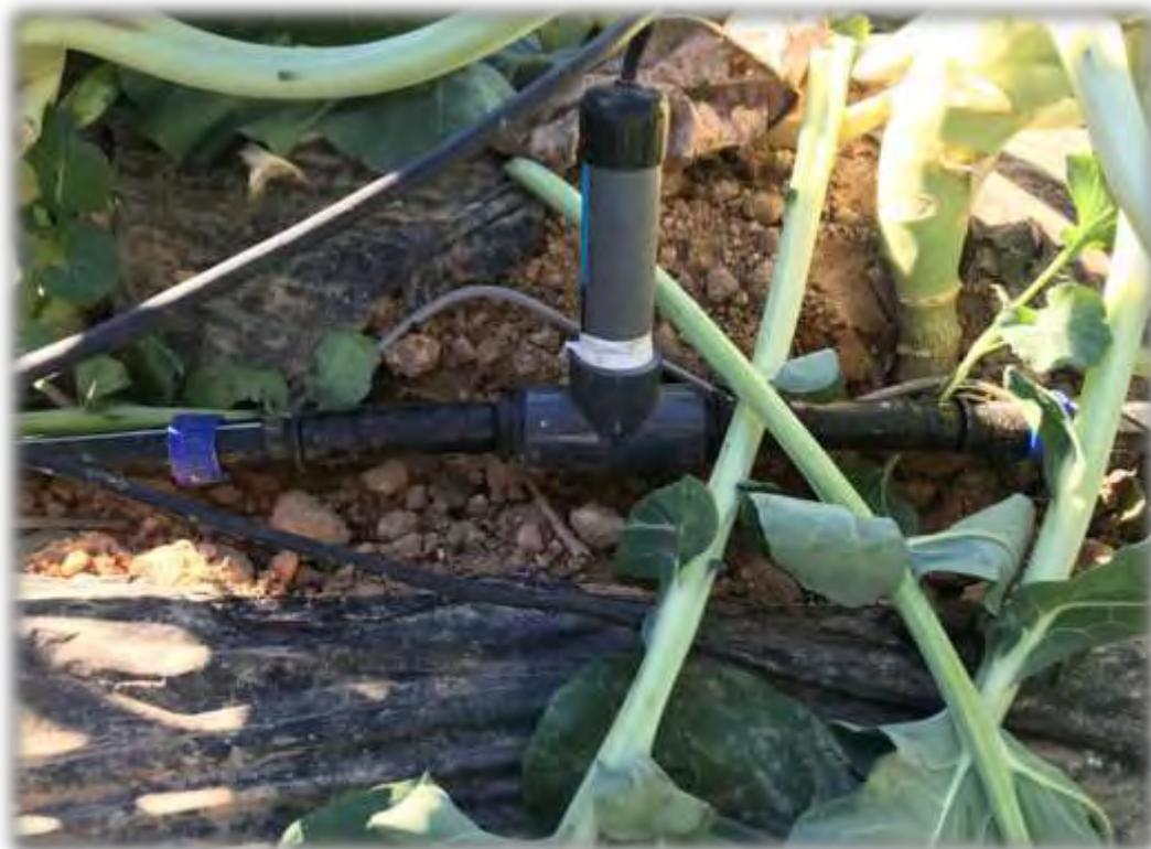
Imagen n°6 Conductímetro para medida de CE en agua de riego
