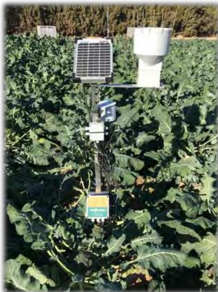
**Imagen nº1** Estación de tensiómetros para el control de riego
