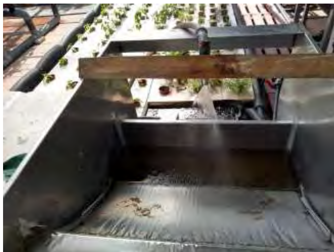
Foto 7. Nuevo sistema de limpieza de deyecciones de los peces (20/05/2021)
