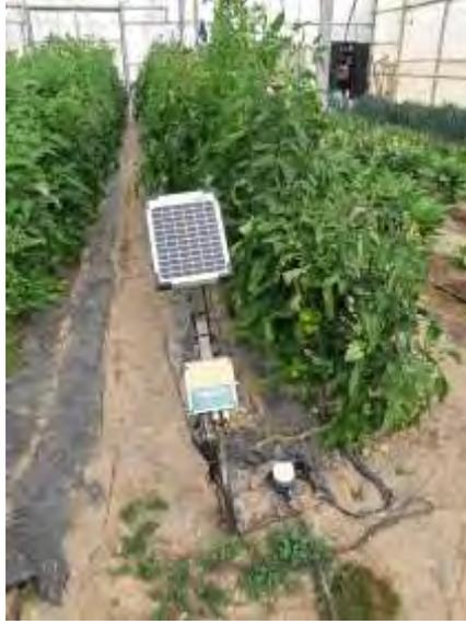
Foto n° 1. Dispositivo de control del riego instalado (03/02/2021).
