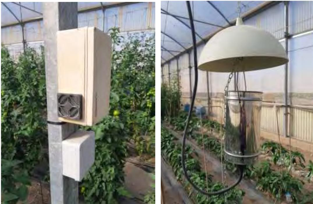
Foto nº 13. Medidor de humedad relativa para el control de apertura y cierre del invernadero (psicrómetro) y sublimador de azufre.
