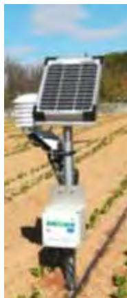
Foto nº 14. Dispositivo con sondas para el control de humedad volumétrica en suelo.
