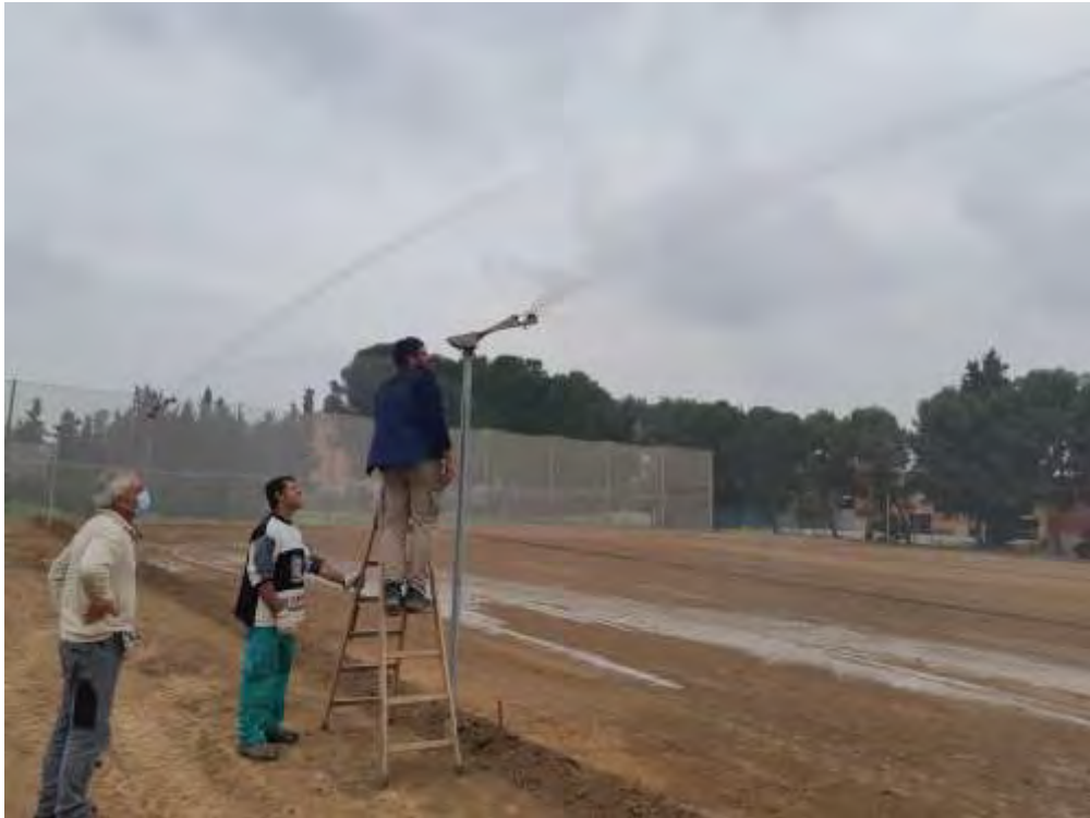
Foto nº 16. Prueba de cobertura de los aspersores (22/11/2021).
