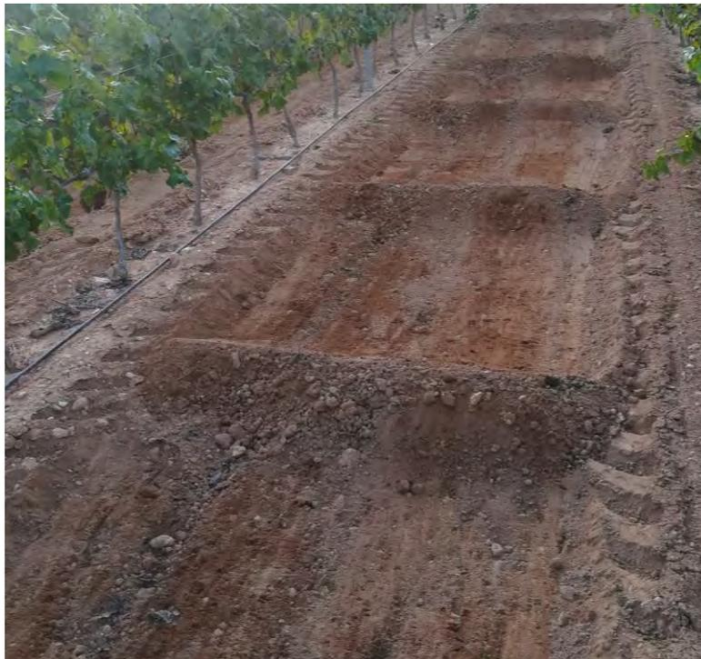
Se aplicará lluvia artificial en la cabecera de las parcelas para evaluar el efecto de las precipitaciones. Al final de cada parcela con laboreo diferencial se dispondrá de un canal de recogida y un depósito. De esta forma cuando se realice el ensayo y se produzca más o menos escorrentía según el tipo de laboreo, se podrá hacer una primera evaluación.
