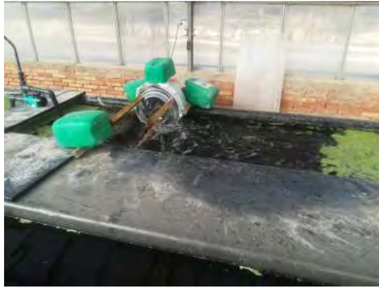
Foto nº 14. Dispositivo artesanal de aireación del agua de la lenteja (28/01/2021).
