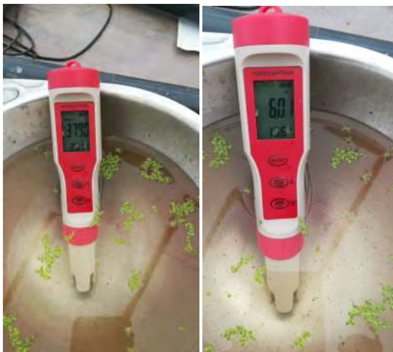
Foto nº 21. Control de la conductividad y pH del agua de la lenteja de agua (5 abril 2021).
