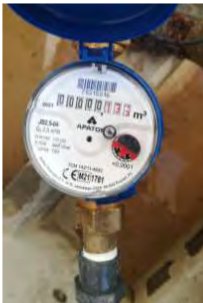
Foto nº 10. Caudalímetro para el control de volumen drenado y programador del riego.
