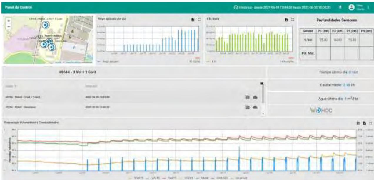
En el panel se observa como debido al aumento de 2 a 4 m<sup>3</sup>/día, se produce una subida de la humedad volumétrica en superficie del 33 al 35% y en profundidad del 40 al 43%. Esto obligó a reducir el volumen de riego, al comprobar aumento de percolación profunda.
