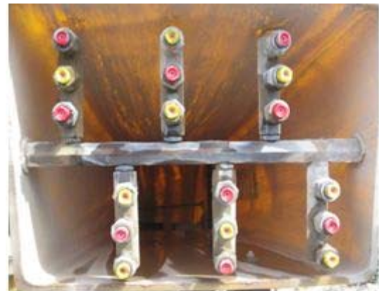
Boquillas montadas en pulverizador tipo cañón
