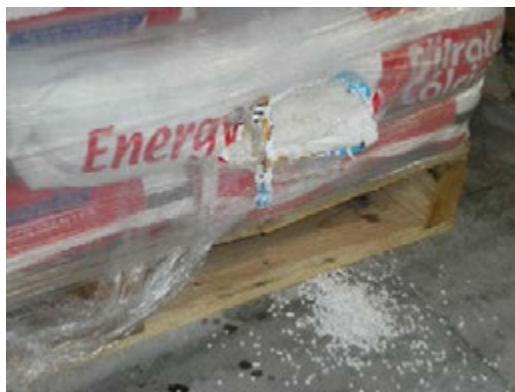
Saco de nitrato de calcio con una rotura que provoca el derrame de su contenido
