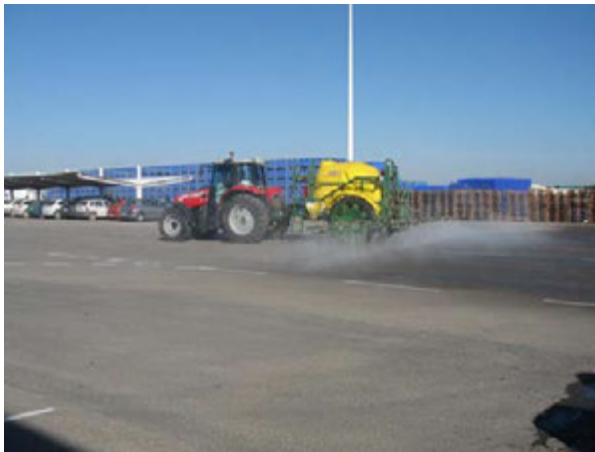
Prueba del pulverizador con agua sobre asfalto
