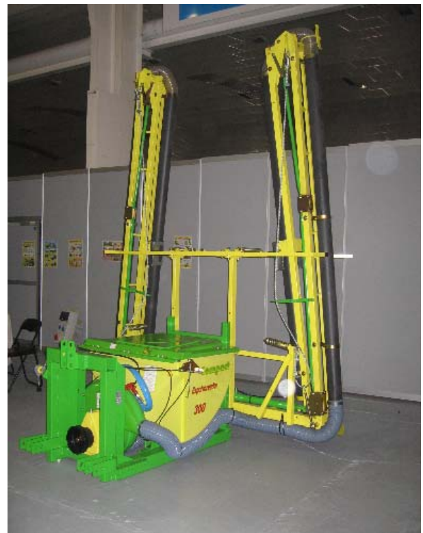
Espolvoreador de grandes dimensiones para ser acoplado a la toma de fuerza del tractor.
