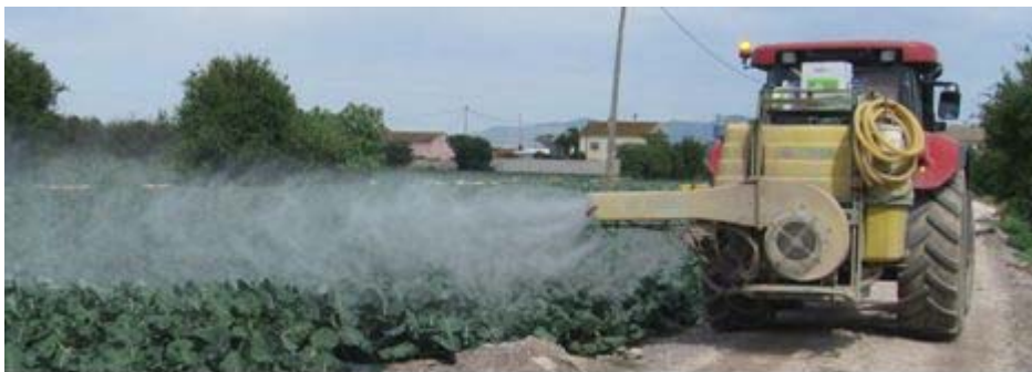
Cañón con ventilador tipo centrífugo
