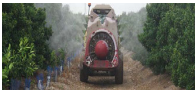
Pulverizador hidroneumático para cultivos arbóreos
