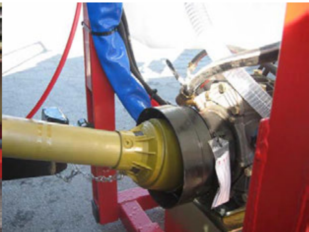
Comprobación de la protección de la transmisión cardánica del eje y la campana de la
