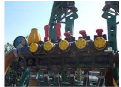
Regulador distribuidor de caudal
