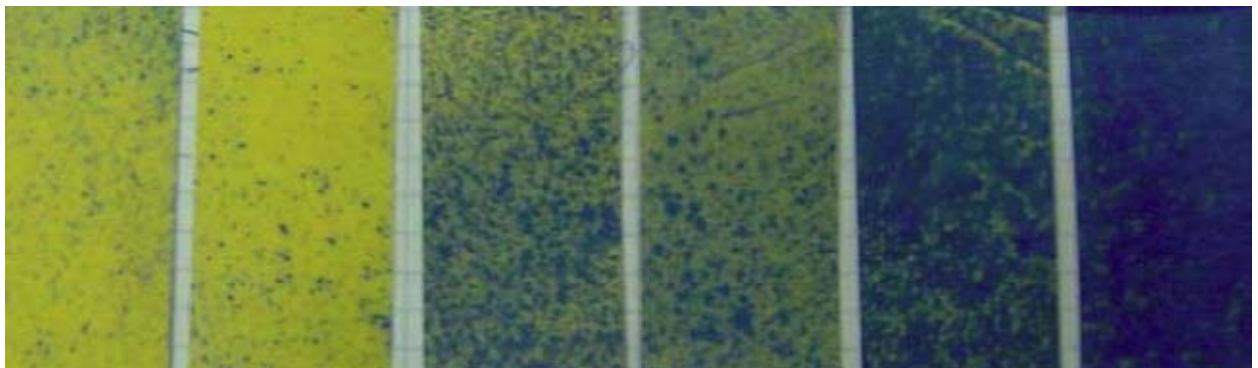
Tarjetas hidrosensibles. Diferentes impactos de gota.
