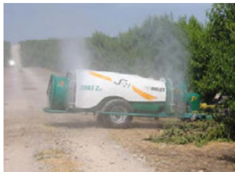
Atomizador turbo alimentado arrastrado
