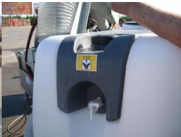
Depósito de agua limpia para uso en lavado de manos y ojos en caso de contacto con
