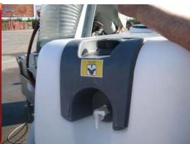
Depósito de agua limpia para uso en lavado de manos y ojos en caso de contacto con fitosanitarios.
