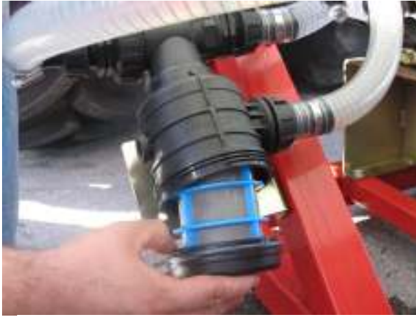
Comprobación del filtro de entrada a la bomba, que no tenga roturas ni suciedad.
