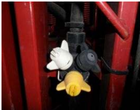
Revolver de boquillas sobre barra distribuidora
