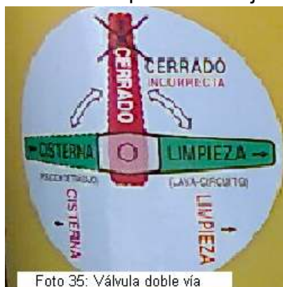
Foto 35: Válvula doble vía
