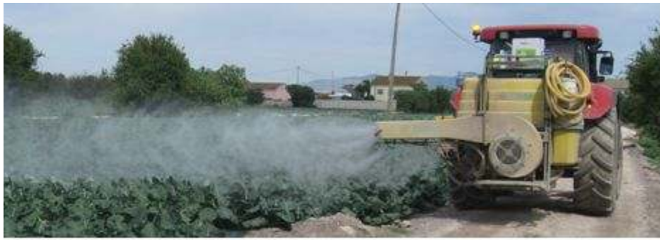
Cañón con ventilador tipo centrífugo
