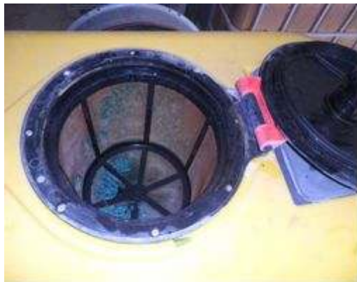
Tapa de llenado deposito.
