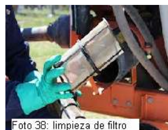
Foto 38: limpieza de filtro
