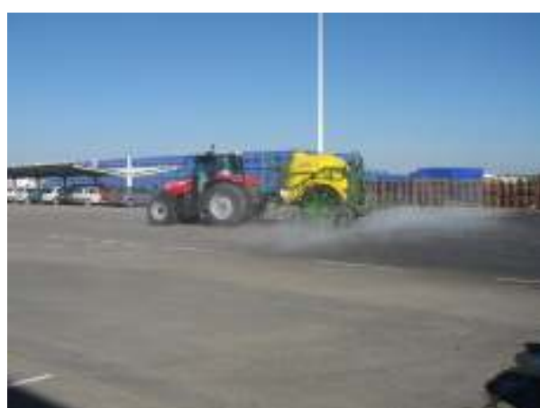
Prueba del pulverizador con agua sobre asfalto
