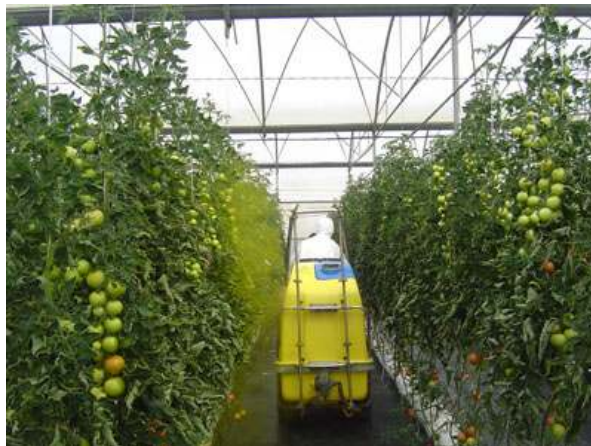
Pulverizador hidráulico, mediante barra vertical
