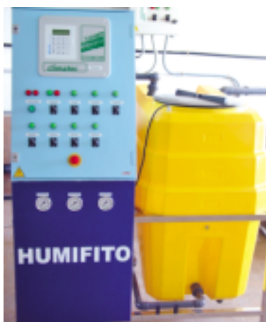
Fig. 2.5. Instalación para humidificación y tratamientos fitosanitarios.
