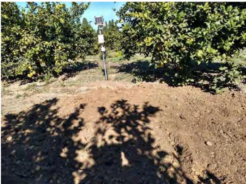
**Foto 1.** Dispositivo para control y visualización en remoto de la humedad del suelo a diferentes profundidades, instalado en la parcela de cultivo de cítricos.
