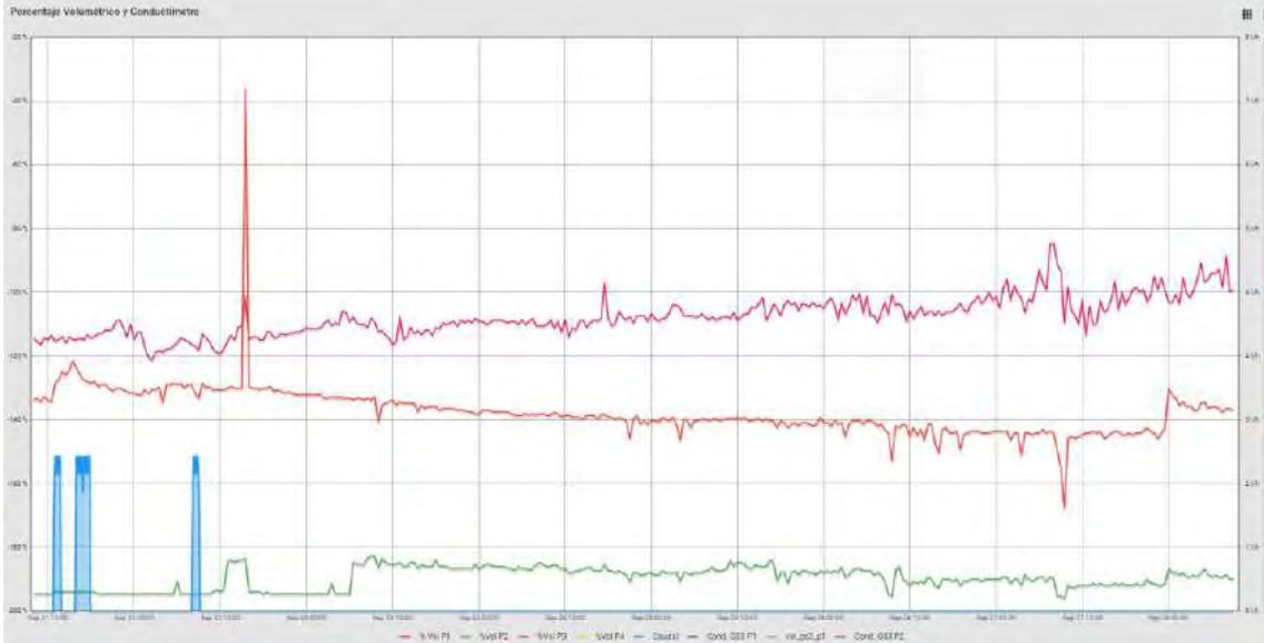
Se instalaron tres sondas, a 25, 40 y 70 cm. Da medida de datos errónea por rotura de la sonda.
