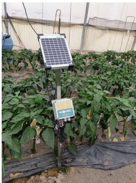
Foto nº 9. Dispositivo de humedad volumétrica en suelo colocado en el invernadero (11/03/2022).
