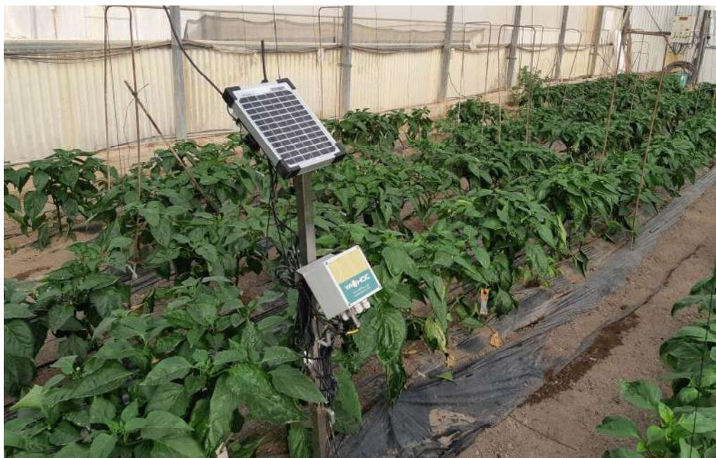
Foto nº 11. Aspecto del invernadero hacia la mitad del cultivo y ubicación de los sensores de humedad volumétrica (11/02/2022).
