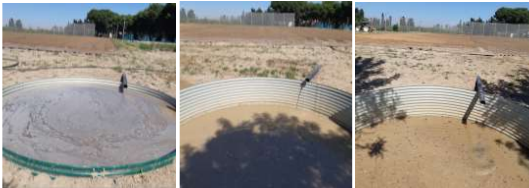
Foto 10. Recogida de escorrentías para una lluvia artificial de 40 mm en 20 minutos. De izquierda a derecha: depósito de parcela labrada a favor de la pendiente, parcela con microahoyado y parcela labrada en curvas de nivel (10/05/2022).
