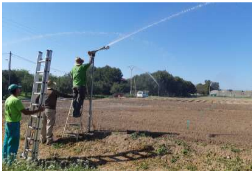
Foto 7. Calibración de los cañones aspersores (10/05/2022).
