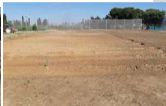
Foto 9. Prueba de erosión con lluvia artificial en las tres parcelas: laboreo a favor de pendiente, miniahoyado y laboreo en curvas de nivel (10/05/2022).
