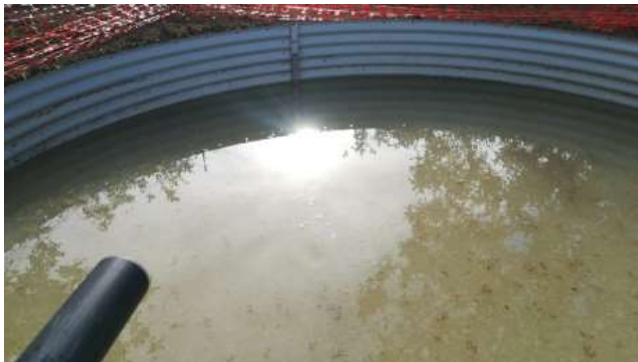
Foto 23. Aguas turbias procedentes de la escorrentía tras una precipitación de 37,5 mm (08/03/2022).
