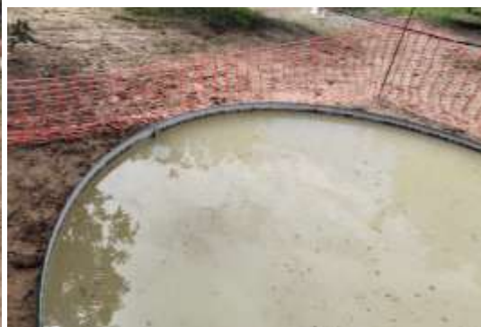
Foto 21. Parcela labrada a favor de la pendiente y depósito de recogida de sedimentos.
