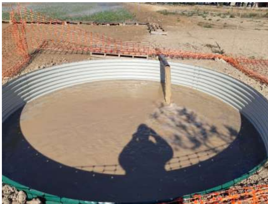
Foto 24. Aguas turbias procedentes de la escorrentía tras una prueba de lluvia artificial de 40 mm en el momento de la misma (08/03/2022).
