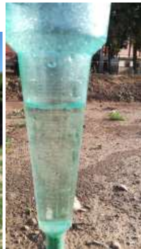
Foto 8. Ajuste de la precipitación por medio de pluviómetros (10/05/2022).
