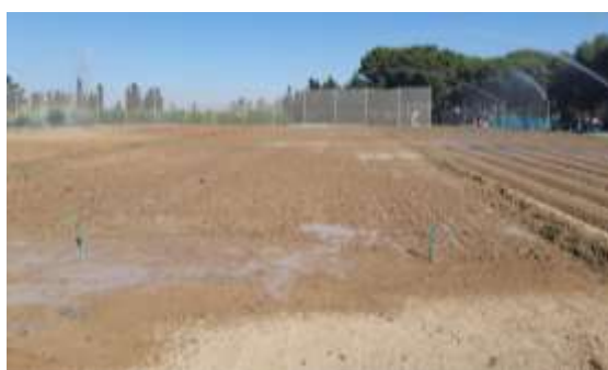
Foto 9. Prueba de erosión con lluvia artificial en las tres parcelas: laboreo a favor de pendiente, miniahoyado y laboreo en curvas de nivel (10/05/2022).
