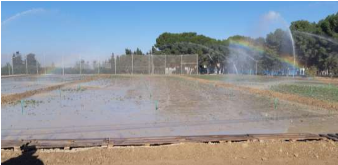
Foto 6. Simulación de lluvia artificial con cañones aspersores (02/03/2022).
