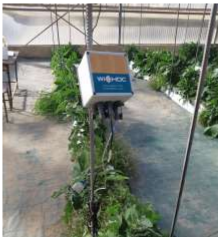
Foto nº 12. Sonda de medida de humedad volumétrica en saco de fibra de coco (18/02/2022).
