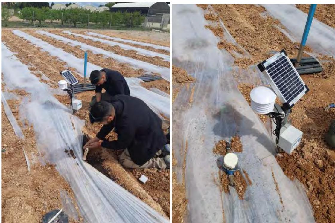
Foto 9. Colocación de dispositivos de control del riego, sondas de humedad y caudalímetros (13/04/2022).
