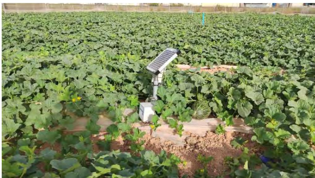
Foto 10. Dispositivo de control de humedad en suelo instalado en el cultivo de melón (16/06/2022).
