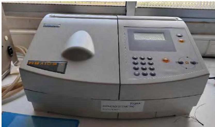
Foto 18. Espectrofotómetro para analizar los nitratos de los lixiviados (27/12/2022).
