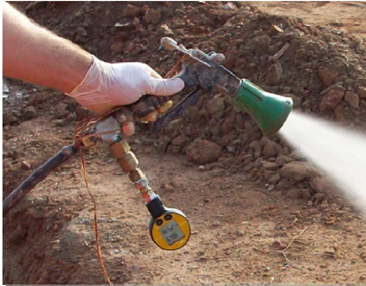
Manómetro instalado al final de la manguera para cuantificar las pérdidas de carga.
