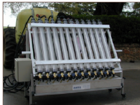
b) equipos que requieren la extracción de las boquillas de la máquina.
