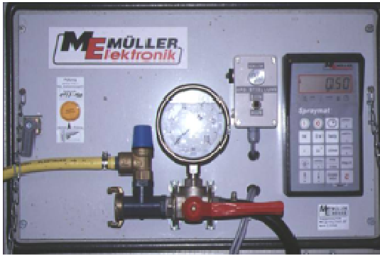
Instrumentación para la medida de la capacidad de la bomba.
