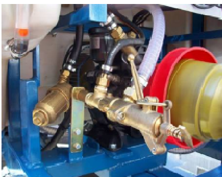
Dificultad para acceder a los controles desde el puesto de conducción.
