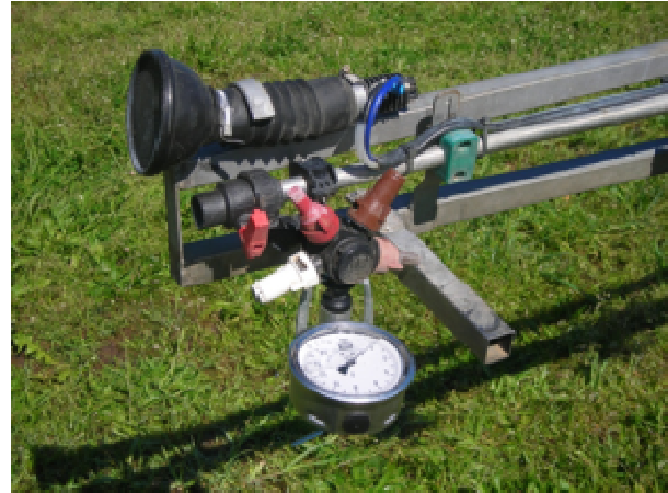
Manómetros para la comprobación del equilibrio de presiones entre los diferentes sectores de la barra.
