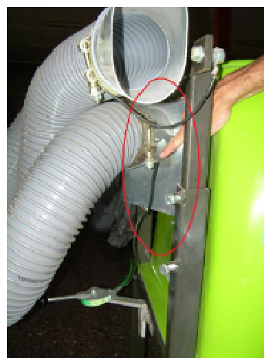
Partes metálicas del equipo conectadas entre si.
