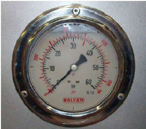
Resulta difícil leer la escala de este manómetro.
