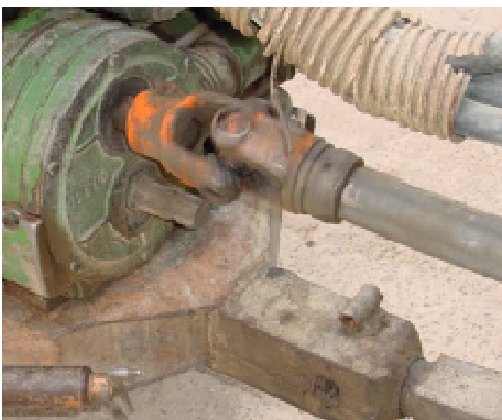
No existe la cadena de fijación en el árbol de la máquina.
