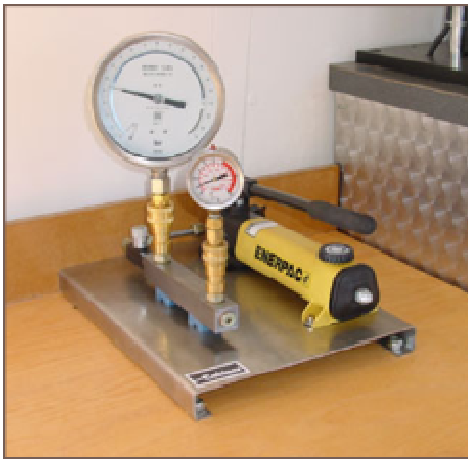
Diferentes tipos de contrastadores de manómetros.
