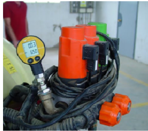
Si el manómetro del equipo no puede desmontarse y/o se trata de un instrumento electrónico, la contrastación se puede realizar instalando un manómetro contrastado en la máquina y haciendo la contrastación pertinente.
