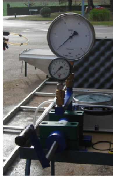
Desmontando el manómetro de la máquina y realizando la contrastación.
