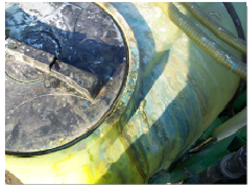
Cierre deficiente de la tapa del depósito.
