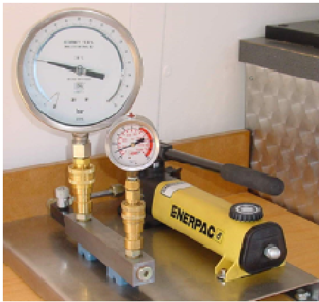
Si el manómetro del equipo no puede desmontarse y/o se trata de un instrumento electrónico, la contrastación se puede realizar instalando un manómetro contrastado en la máquina y haciendo la contrastación pertinente.
