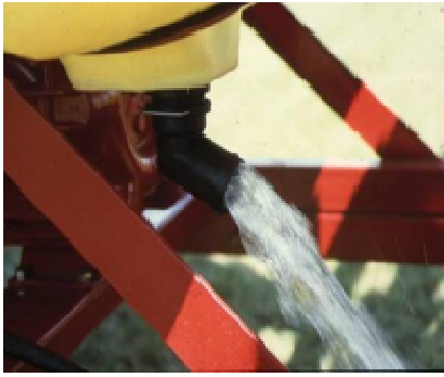
Vaciado correcto con válvula de vaciado del depósito.
