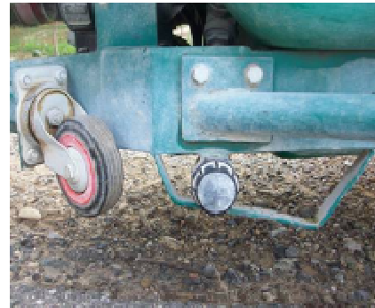
Sistema de vaciado de accionamiento difícil.
