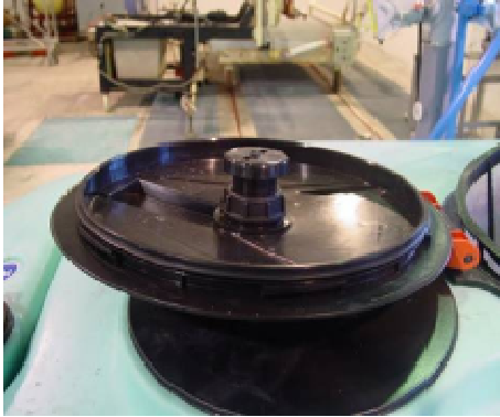
Sistema de compensación de presión en buen estado y con funcionamiento adecuado.
