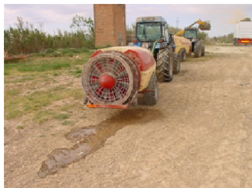
Cierre deficiente de la tapa del depósito.
