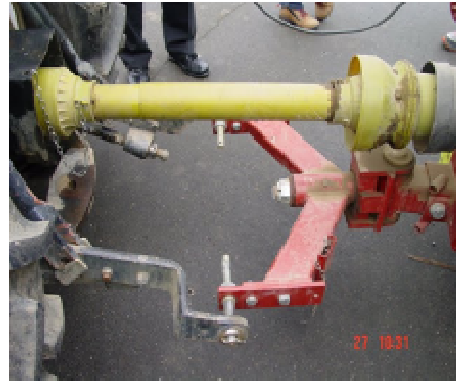
No existe la cadena de fijación en el árbol de la máquina.
