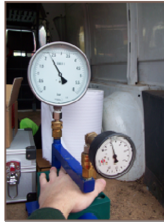
Diferentes tipos de contrastadores de manómetros.
