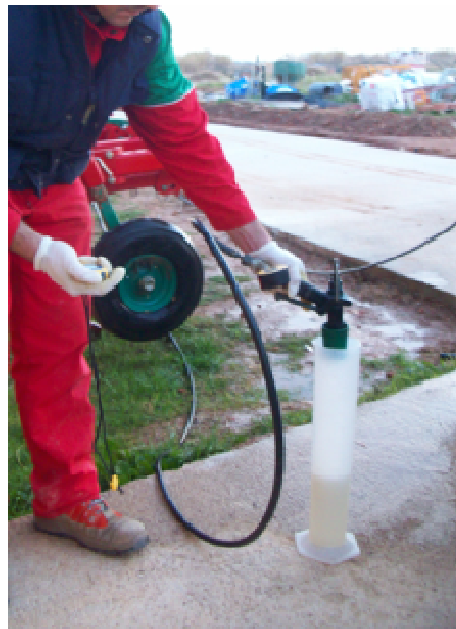
Recogida del líquido de una pistola de pulverización con una probeta graduada.
