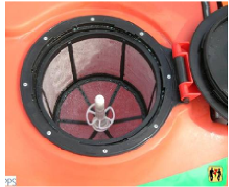
Estado correcto del filtro de llenado.
