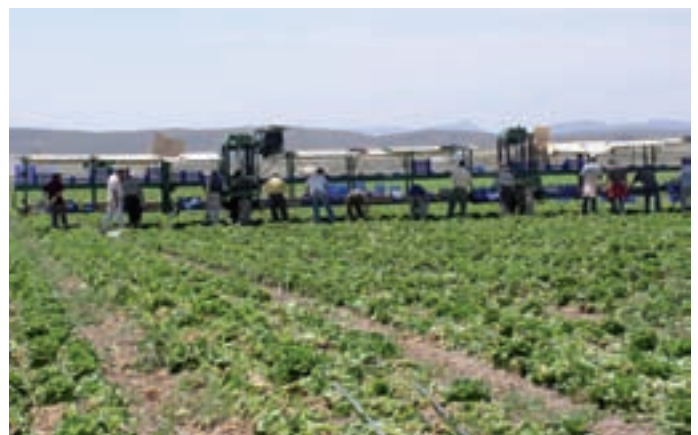
Recolección de lechuga mediante lineales arrastrados.
