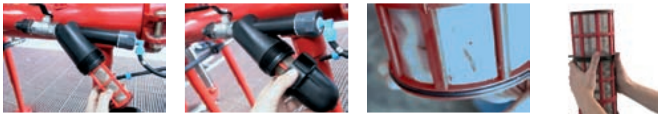
Fotografía 1.6: Filtros de malla. (Foto: Sistema AZUD, SA.)
