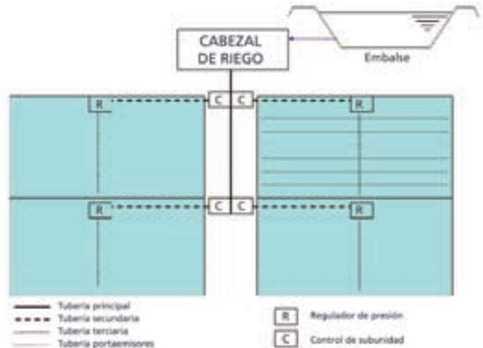
Figura 1.1: Esquema tipo de una instalación de riego por goteo (embalse-cabezal-red distribución-parcelas de riego).
