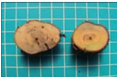
Daños de hongos de madera.
