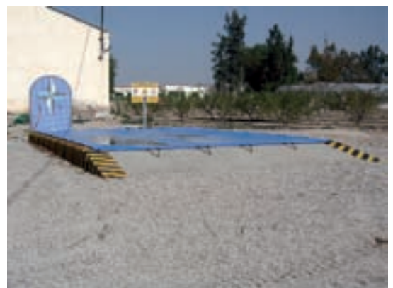
Imagen 21. Unidad de limpieza de atomizador.
