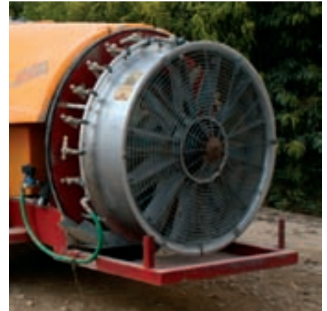
Imagen 18. Ventilador y arco de distribución de boquillas.
