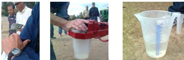
Comprobamos que el agua depositada en la probeta se corresponde con los 0,875 l/minuto, teniendo en cuenta que puede haber un margen de error del 5% máximo.
