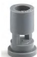
Esta boquilla se utiliza para agitar el líquido en el interior del depósito. El efecto Venturi de la boquilla aumenta varias veces la agitación respecto al líquido que pasa por el orificio calibrado de la boquilla. Recomendada para la agitación continuada de mezclas de productos fitosanitarios.
