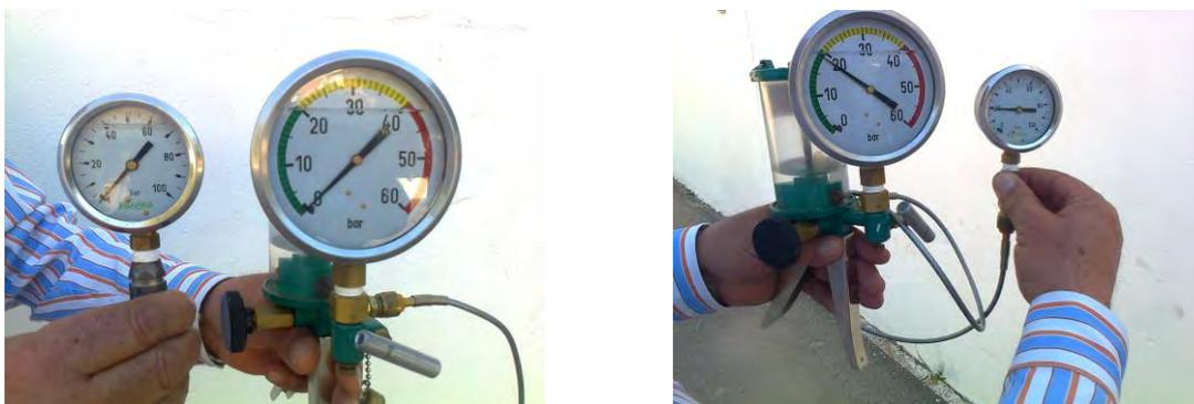
Con la ayuda de un comprobador de presión para manómetros y teflón, se realiza la comprobación del manómetro de la máquina, con la participación de los asistentes a la práctica.
